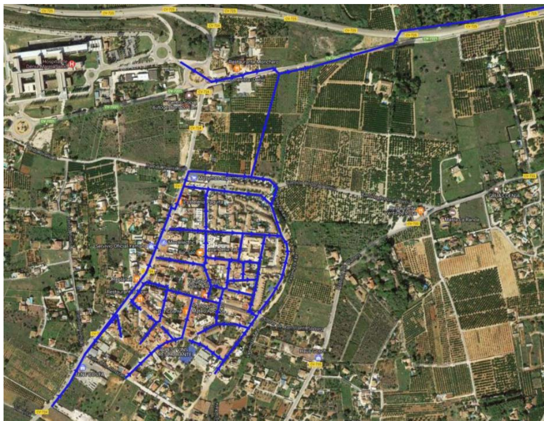
8- Esquema de la red existente de alcantarillado. Actualización 2017 PD Saneamiento. Aguas de Denia SA. (A este esquema hay que añadirle la red construida por las obras de urbanización de laas calles Ximo l'Almassera y Morxama (hoy Roser Cabrera).
